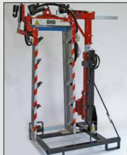
ERO-Laubschneider Modul Line einseitig Überzeilen auf Abstellvorrichtung (Option) mit hydraulischer Höhenverstellung
