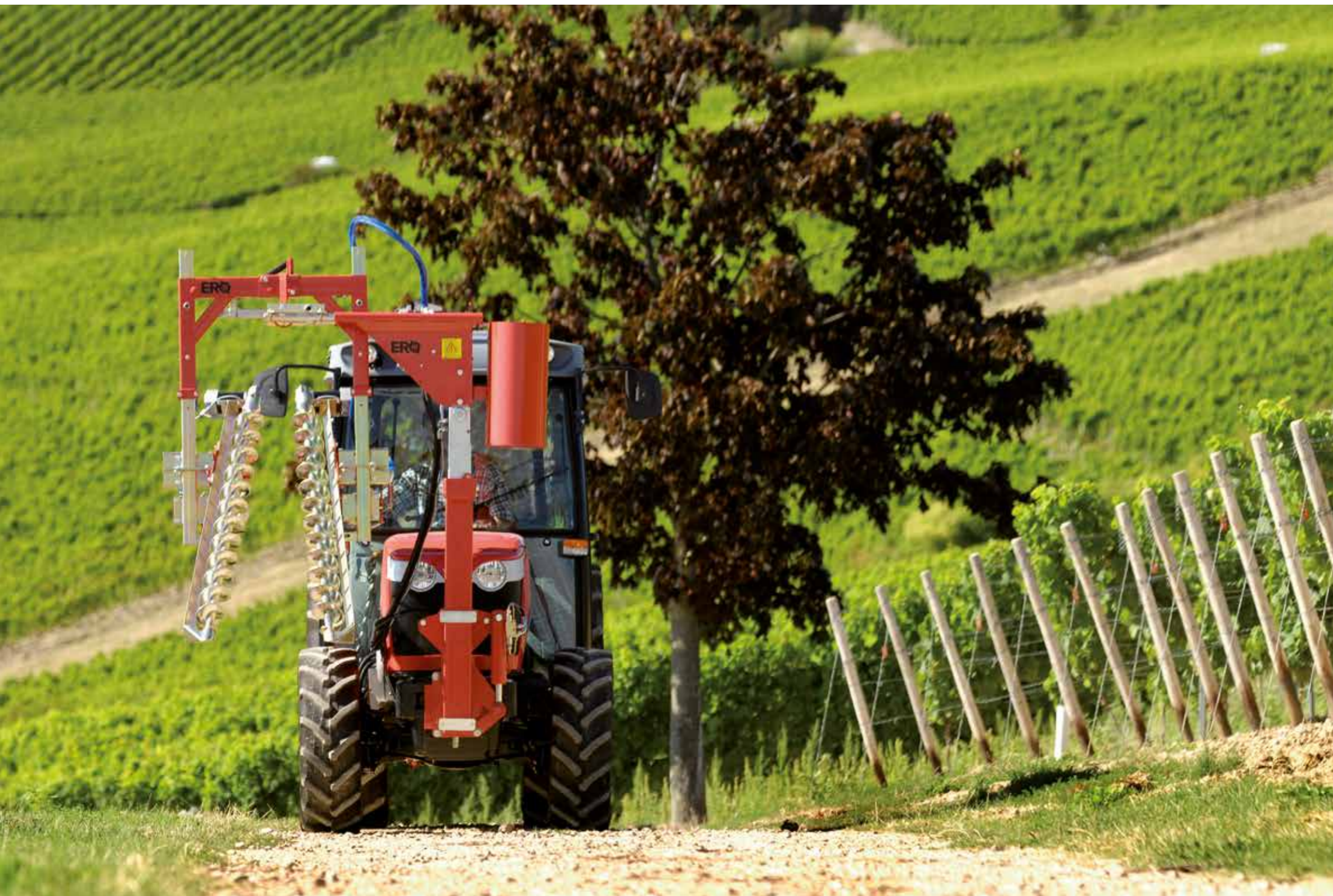
Laubhefter mit Führungsbändern und hydraulischem Gipfelgerät
